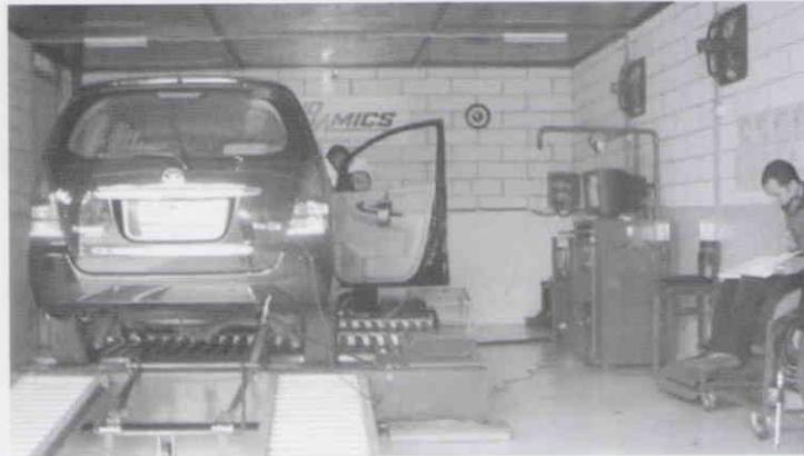
Gambar 1 .Peralatan *Dyno Test*, Innova sedang melakukan *Dyno Test*.
