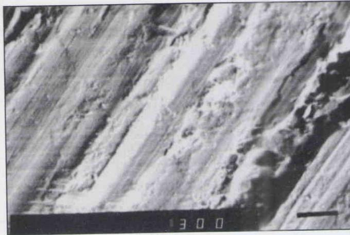
Gambar 7. Permukaan material *Bottom cone* dengan perbesaran 300 kali
