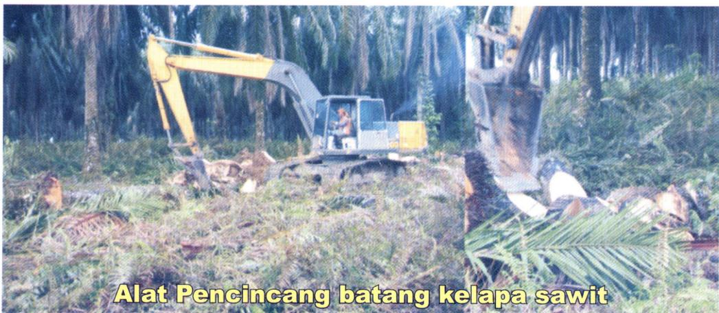
**b. Batang kelapa sawit dicincang (*chipping*)**
