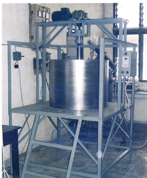
Gambar 9. Reaktor pembuatan sabun cuci dari fraksi padat pabrik mintyak goreng super mini dengan kapasitas 150 kg/batch
