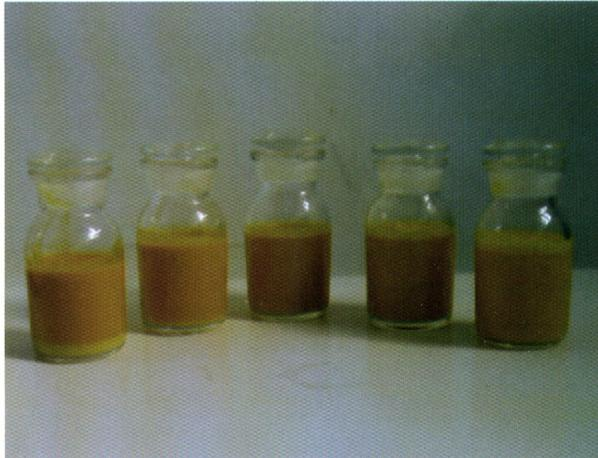
Gambar 3. Produk emulsi minyak makan merah dengan rasio minyak dan air 0.6 : 0.4 (v/v), bahan pengemulsi campuran Span-40 dan Tween-40, serta beberapa tingkat konsentrasi bahan pengemulsi dari kiri ke kanan 1, 1.5, 2, 2.5 dan 3%
