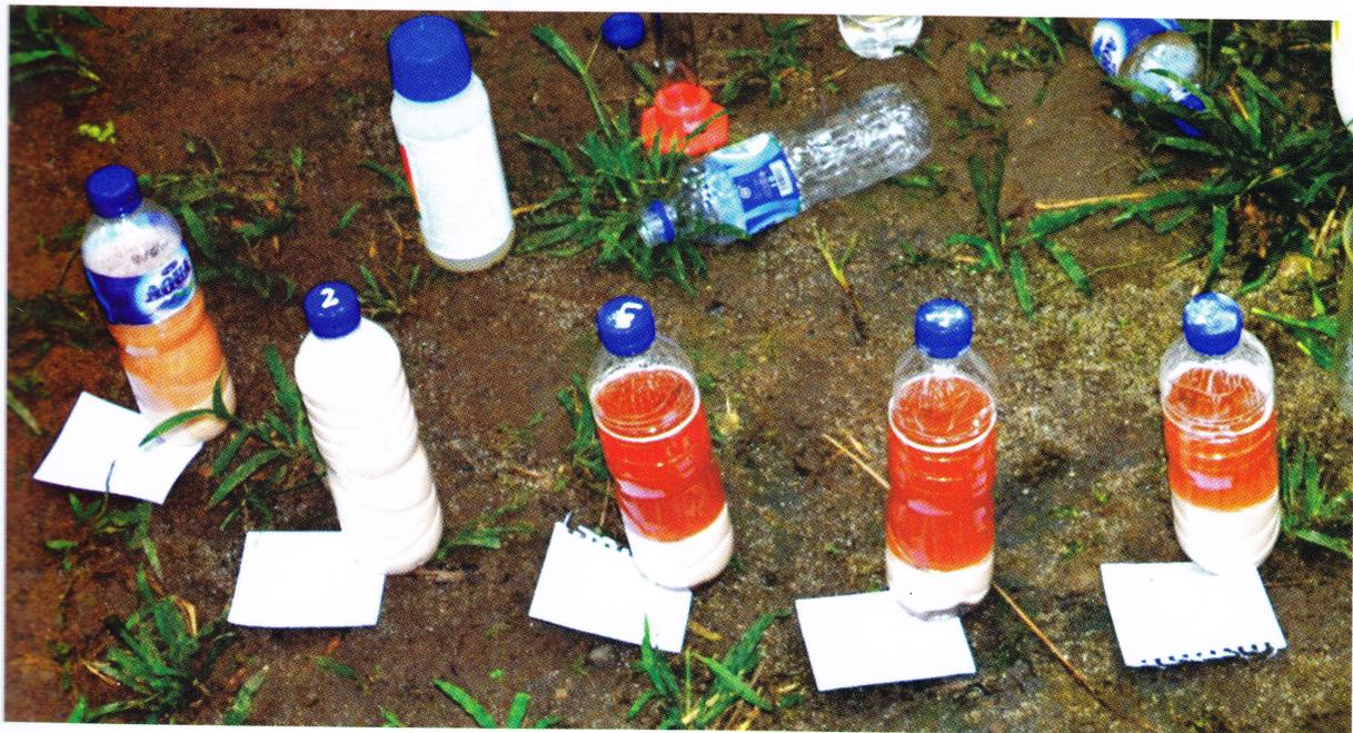
Gambar 6. Hasil kalibrasi bahan untuk fogging yang terbaik adalah yang putih seperti susu
